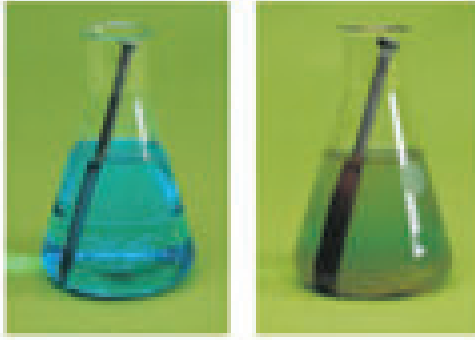
படம் 10.2 இரும்பு காப்பரை இடப்பெயர்ச்சி செய்தல்
